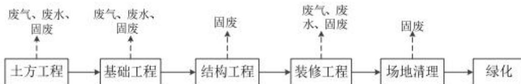
图 2-2 项目施工期工艺及产污节点图
